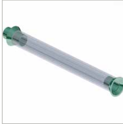
Przyciąć rurę okładzinową na długość, zamocować stożek podporowy i stożek centrujący
