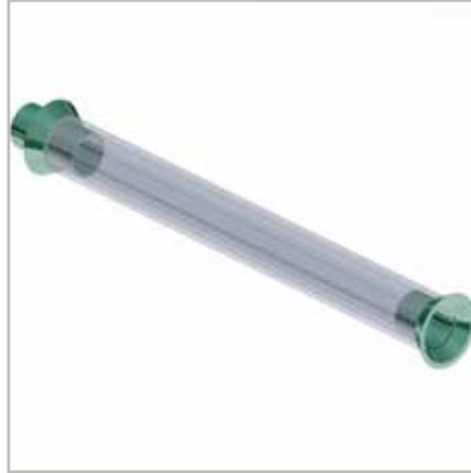
Hüllrohr ablängen, Stützkonus und Zentrierkonus aufstecken
