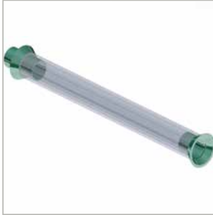
Mantelpijp op maat maken, steunconus en centreerconus opsteken
